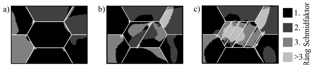
Abb. 5.2 Verteilungen der in Abb. 5.1a-c maximal beanspruchten Gleitsysteme, die farblich in Abhängigkeit des Schmidfaktors gekennzeichnet sind (schwarz bis hell grau).
