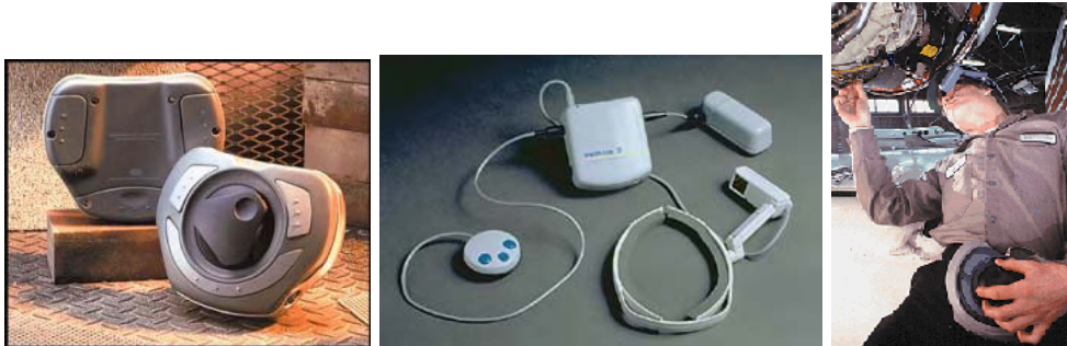
Abb. 4.3-e: VuMan zur Überwachung der richtigen Verkabelung bei Flugzeugen am Carnegie Institute of Technology in Zusammenarbeit mit Boeing. 65
