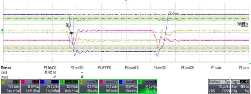
Abb. 4.13: Schaltverhalten mit Z-Dioden-Ansteuerung (Variante 2).
