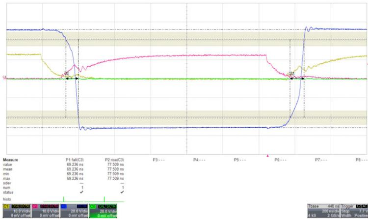
Abb. C.12: HEXFET:  $t_{\text{fall}}$ : s. P1 |  $t_{\text{rise}}$ : s. P2 |  $t_{\text{off}}= 194 \text{ ns}$  |  $t_{\text{on}}= 78 \text{ ns}$
