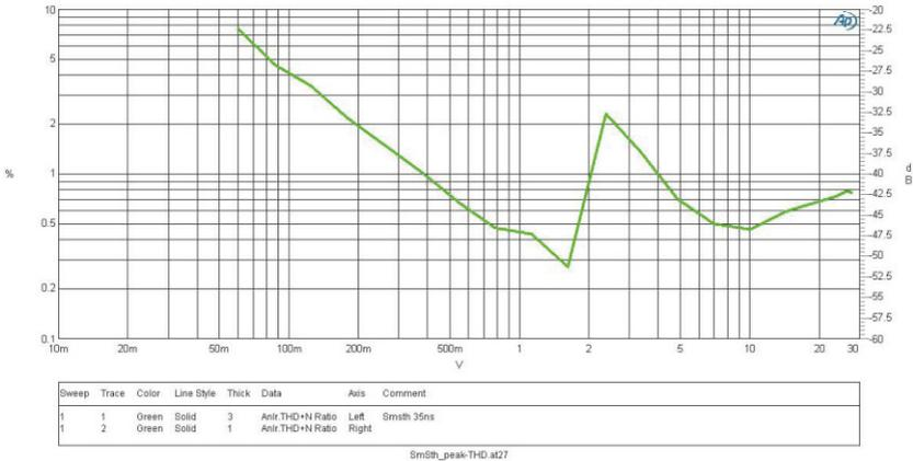
Abb. B.31: Übermäßiger THD infolge eines Layout-Fehlers auf der SiC-JFET-Leiterplatte.
