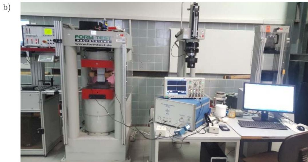
Abbildung 5.17: Akustoelastischer Versuchsaufbau: a) Schema, b) reales Experiment.
