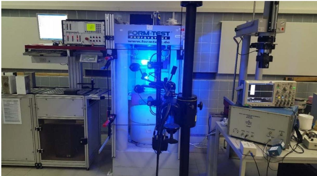
**Abbildung 5.18:** Versuchsaufbau des digitalen Bildkorrelationssystems (Aramis, GOM) zur kontaktlosen Dehnungsmessung.
