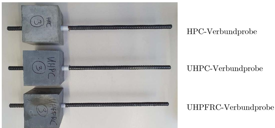
Abbildung 5.40: Stahlbetonverbundproben aus HPC, UHPC und UHPFRC.
