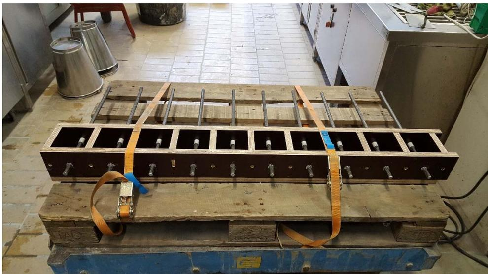
**Abbildung 5.42:** Holzschalung zur Herstellung der Ausziehproben mit eingesetzten Bewehrungsstählen.
