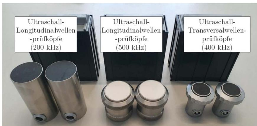
Abbildung 5.4: Verwendete Niederfrequenz-Ultraschallprüfköpfe.
