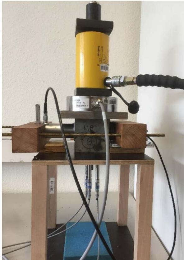
**Abbildung 5.43:** Realer experimenteller Aufbau zur Durchführung der Ausziehversuche und der Ultraschallmessung.
