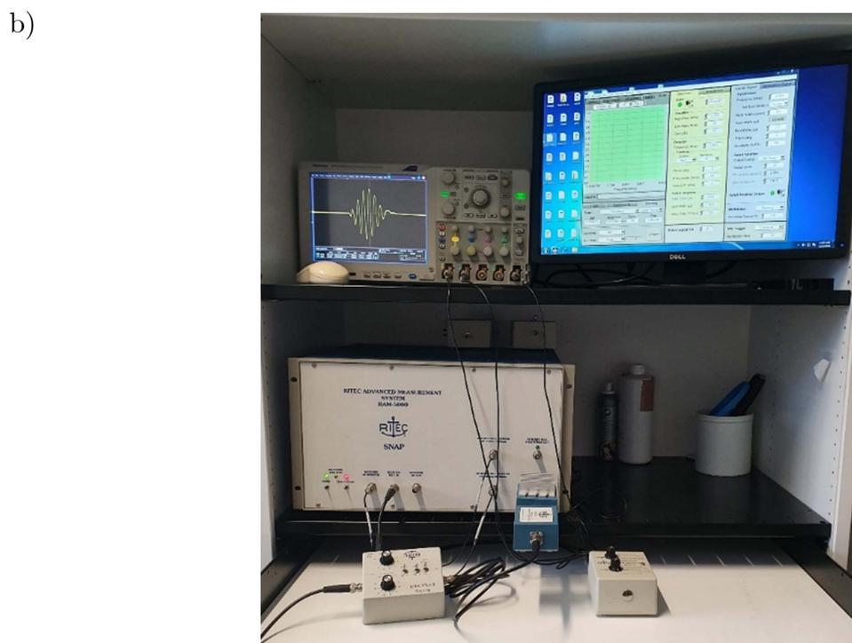
**Abbildung 5.7:** Versuchsaufbau zur Transversalwellen-Prüfung im Impuls-Echo-Modus: a) Schematische Darstellung, b) Reales Experiment.
