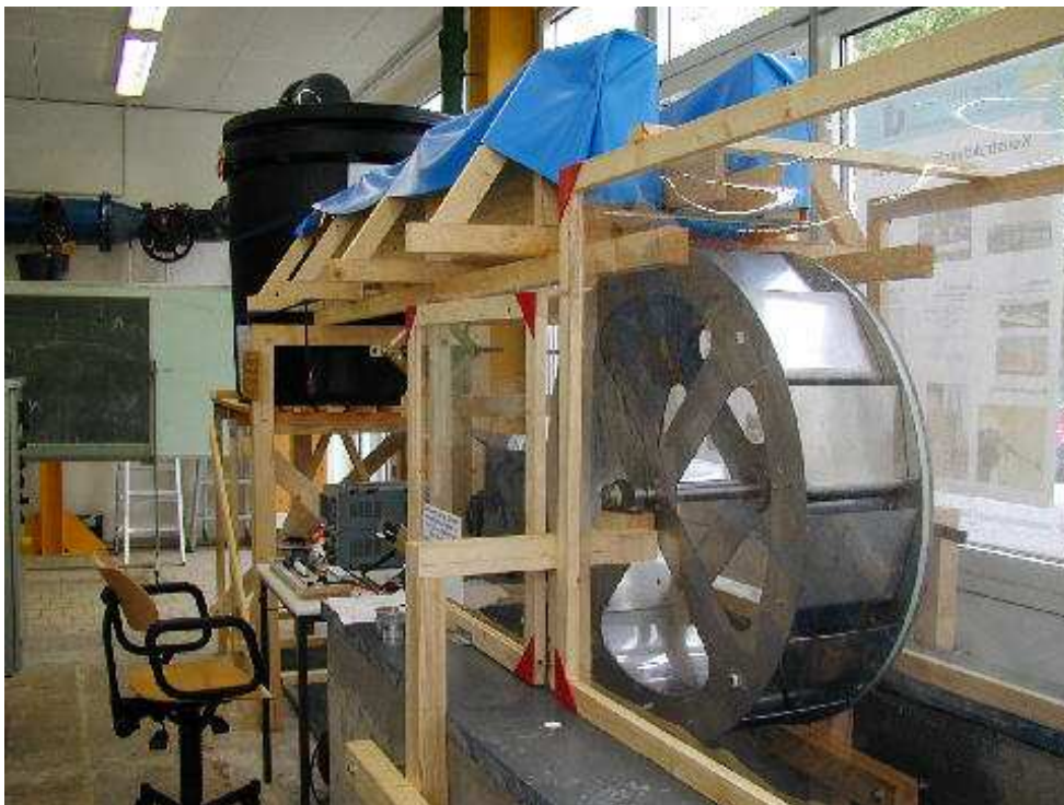
Bild 9.4: Prüfstand für das Wasserradmodell
