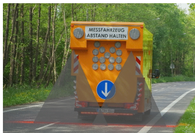
Abbildung 2-2: Multifunktionales Erfassungssystem zur Fahrbahnoberflächenanalyse - MEFA (Quelle: BAST)
