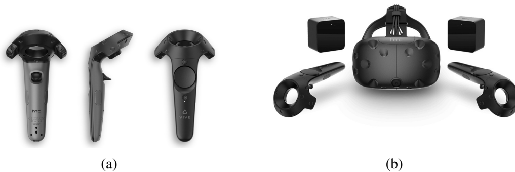
Abbildung 3.4: (a) Diverse Ansichten eines HTC Vive Controllers (Quelle: [VR 17]) und (b) die notwendigen Komponenten (HMD, Controller, Basisstationen) zum Betrieb der HTC Vive (Quelle: [HTC17a]).
