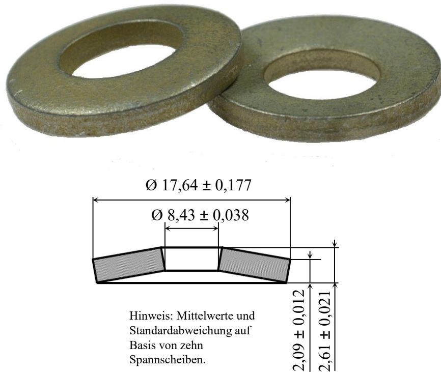
Bild 57: Spannscheiben DIN 6796 und deren Abmessungen
