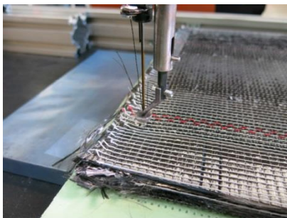
Nähfuß und gestapelte Gelege vor dem Tufting
