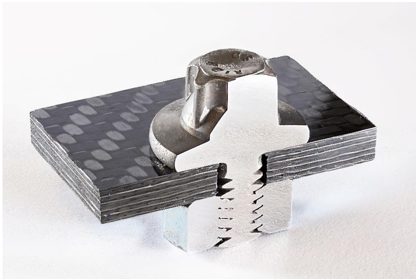
Bild 8: Prinzipieller Aufbau eines Vorspannkraftrelaxationsprüfkörpers im Querschnitt
