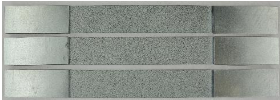
Bild 27: Zugproben zur Ermittlung der in-plane Eigenschaften
