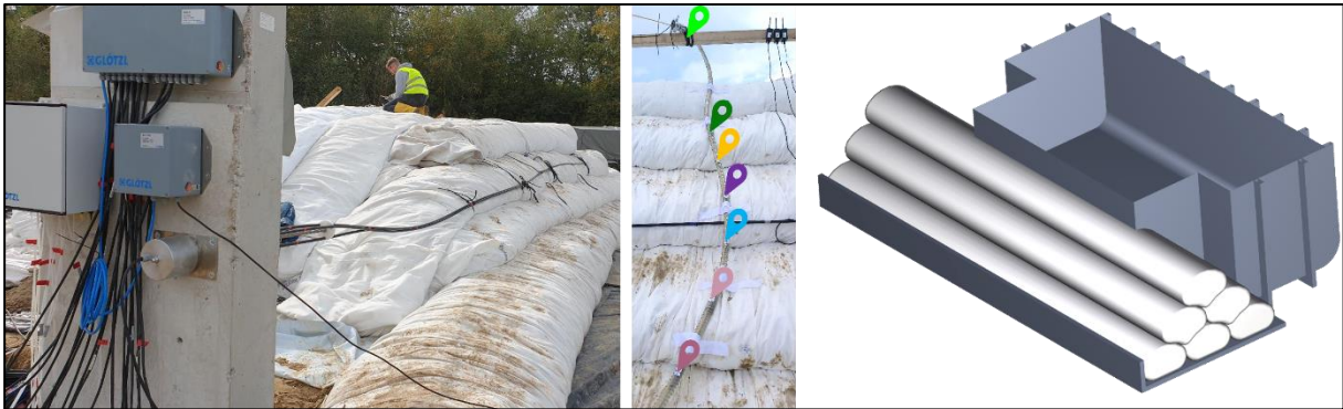
Abbildung 2-3: Instrumentierter Testdeich (links) mit SINC (mitte) und Skizze des Deichs mit Container
