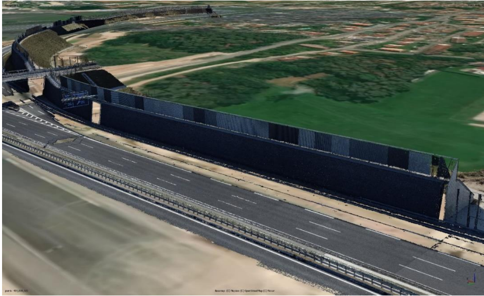
Abbildung 3-18: 3D-Modell – UAV-Photogrammetrie BAB A73, BW 21.
