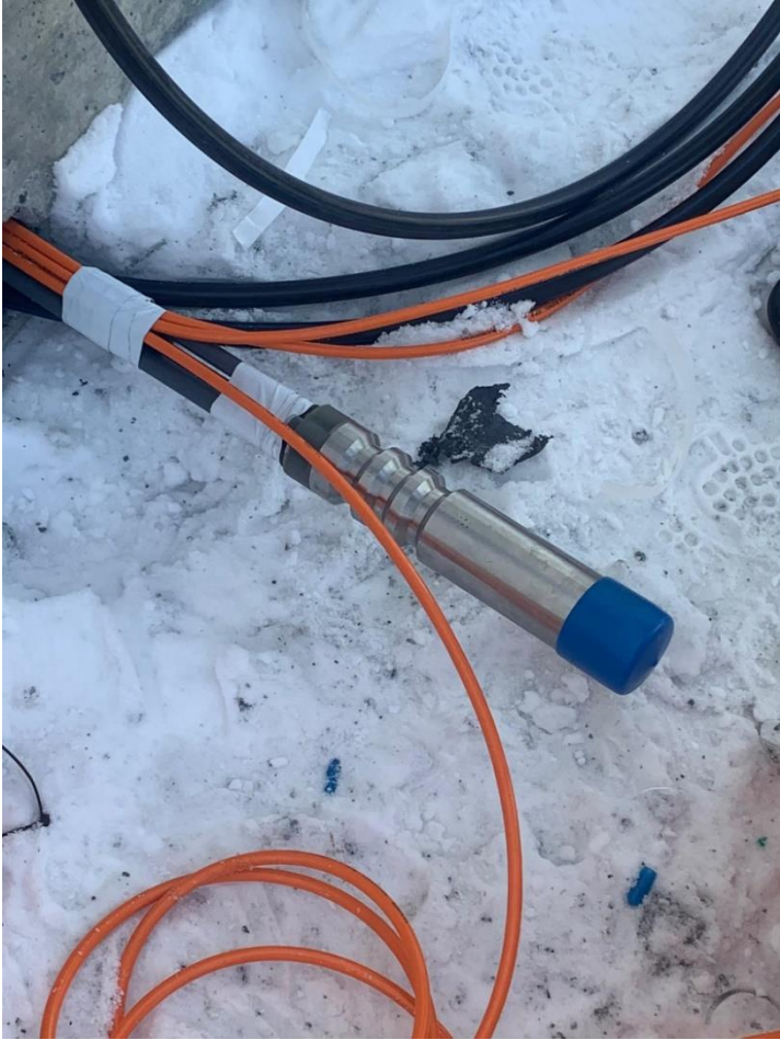
Abbildung 4.6: Extensometer-Messkopf mit elektrischen Wegaufnehmern
