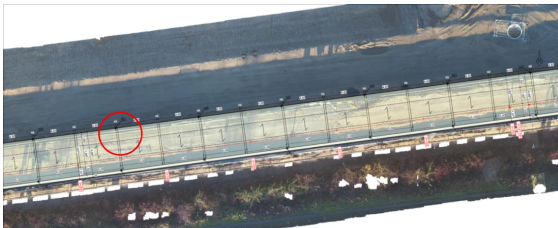
Abbildung 3-8: Kontrolle Geogitterverlegung Plan/Ist.
