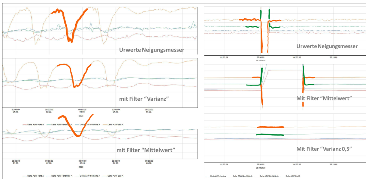
Abbildung 2-2: Vergleich der Filter Mittelwert und Varianz
