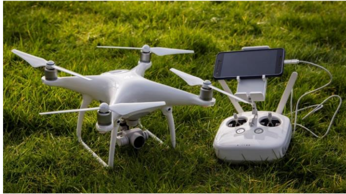
Abbildung 2-5: Equipment für UAV-Photogrammetrie.
