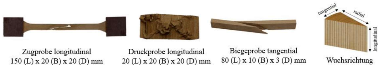
Abb. 2: Testkörper aus Robinienholz zur mechanischen Charakterisierung
