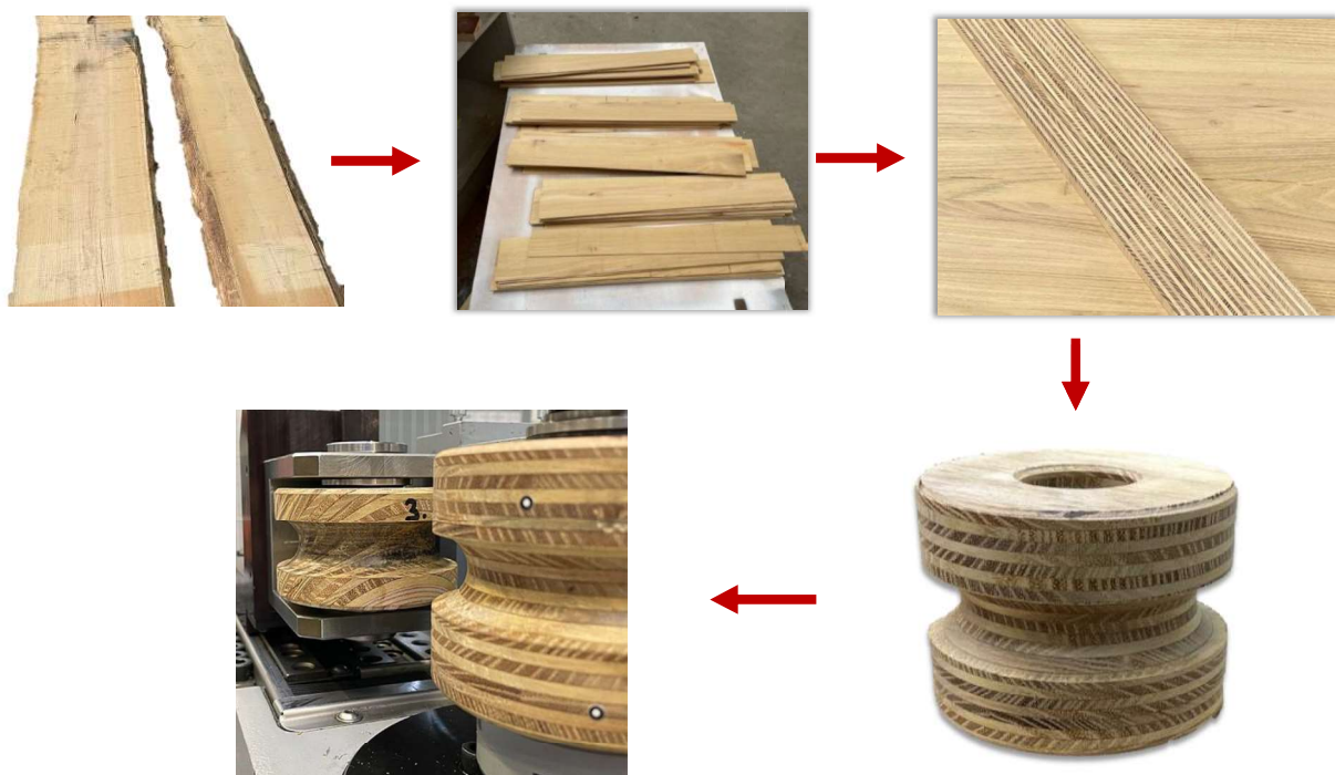
Abb. 6: Herstellungsprozess der Umformwerkzeuge als Schichtverbund aus Robinienholz
