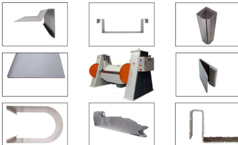
Abb. 3: Fertigungsflexibilität des Schwenkbiegeverfahrens, nach [8]
