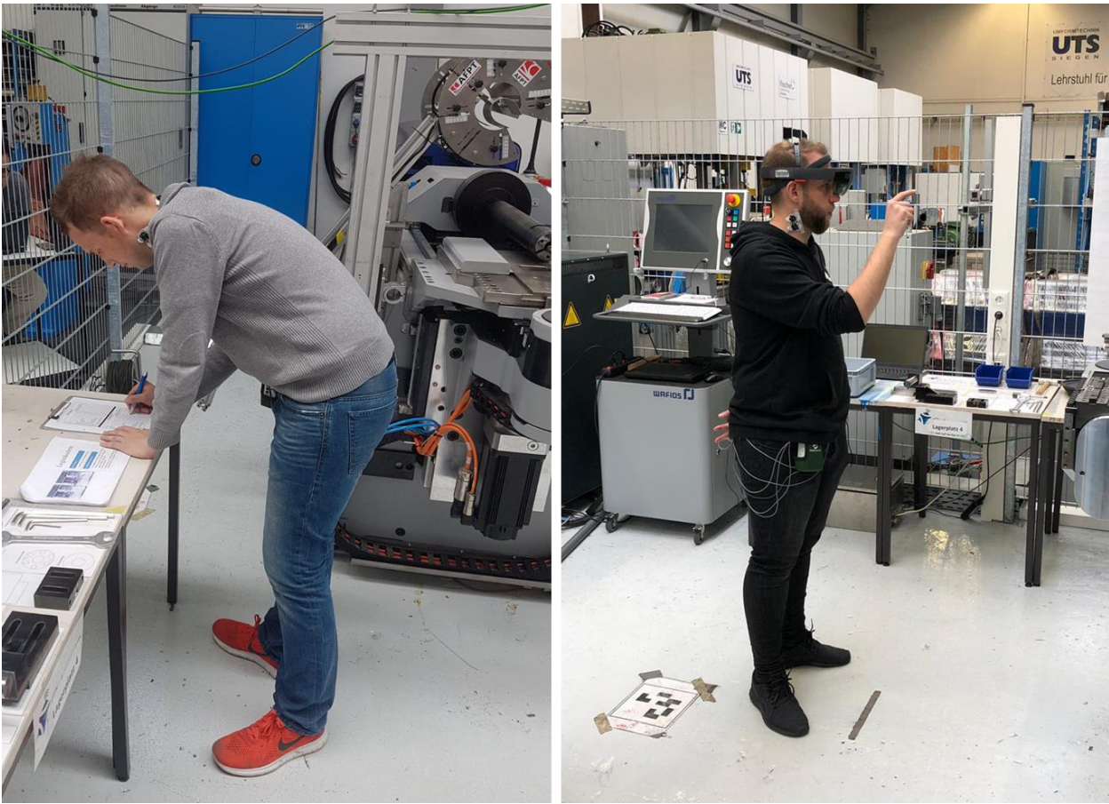
Abb. 8.19: Körperhaltung während des Einsehens der Rüstinstruktionen ohne (links) und mit Nutzung der Datenbrille (rechts)
