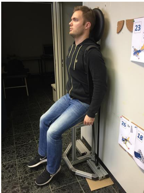
Abb. 7.17: Methode zur maximalen Beanspruchung des m. trapezius pars descendens mithilfe des Einsatzes einer Stuhlkonstruktion
