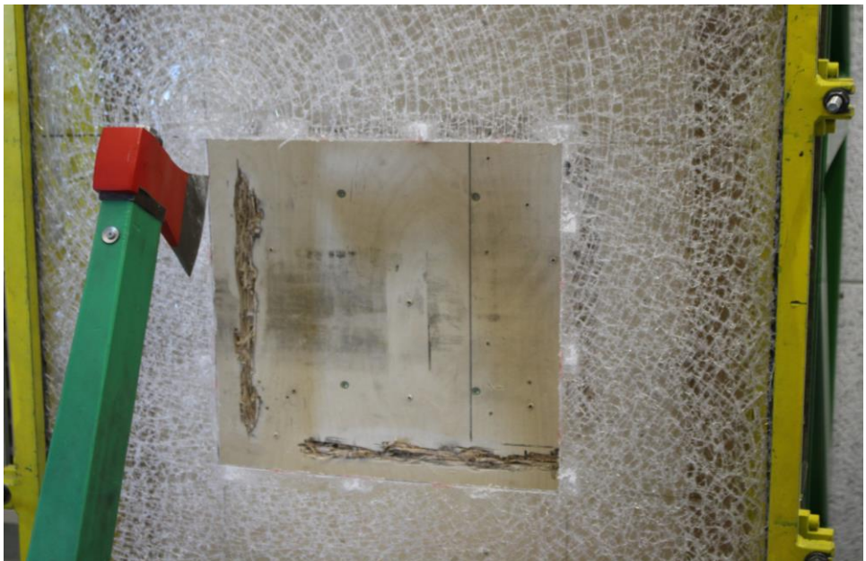
Bild 82 Prüfung mit der Axt an einer Dünnglas-Polycarbonat-Verbundtafel.
