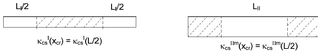
Abb. 7.4: Verlauf der Krümmung aus den Schwindverformungen
