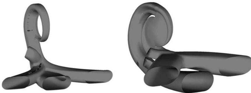
**Abbildung 7.1:** *Abgaskrümmeninnenkontur ohne und mit Trennung der Fluten*
